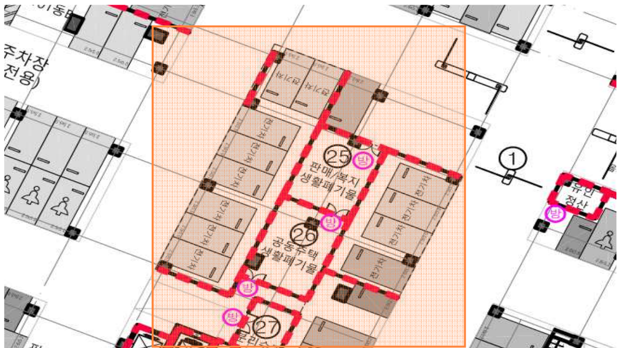
<그림 29> 전기차 충전구역 직근에 위치한 폐기물품 보관장소
